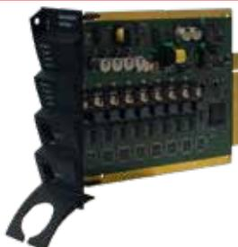
Carte enfichable pour l'unité centrale pour la commande de jusqu'à 8 stations de base raccordées par câble. L'unité de commande est intégré dans l'unité centrale Systevo DECT et traite la communication et la commande des signaux vocaux et de données entre les stations de base raccordées et les téléphones DECT sans fil selon la norme DECT/GAP.
