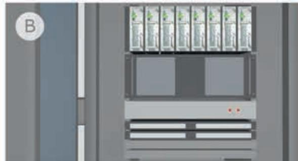
L'installation de l'équipement d'appel central dans le rack 19" comprend un serveur du système, un commutateur système, un système USV pour l'alimentation secourue et une centrale de groupe Systemvo Control. Dans le rack, jusqu'à 7 unités Systemvo Control peuvent être utilisées pour remplacer un système d'appels existant
