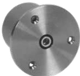
Bloc sensitif jouant le rôle de bloc d'appel avec voyants de localisation et de tranquillisation rouges. Plaque frontale en laiton de 4 mm, chrome galvanisé, diamètre 70 mm et 3 vis hexagonales pour la fixation.
