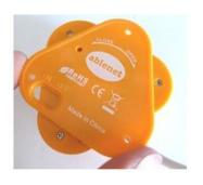
Ce contacteur s'active sans contact par effleurement. Il suffit de s'approcher ou de bouger la main ou toute autre partie du corps jusqu'à 10 mm au-dessus de celui-ci pour l'activer. Un retour sonore et visuel par diode orange signale l'appel. Il possède un support magnétique.
